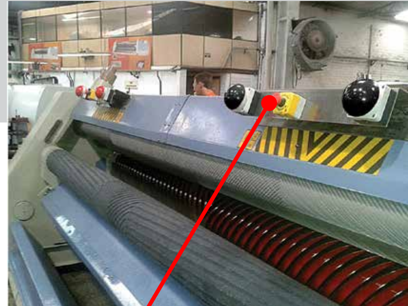
Botão de emergência monitorado por interface de segurança. Quando acionado, desliga a bomba, de modo a abrir a máquina, desligar o movimento do cilindro de navalhas e fechar a proteção articulada
