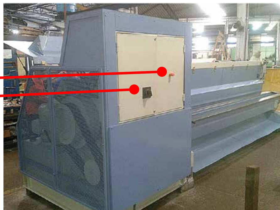
Botão de emergência monitorado por interface de segurança
