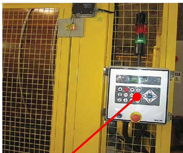
Botão de emergência monitorado por interface de segurança. Quando acionado, todos os movimentos da máquina são interrompidos
