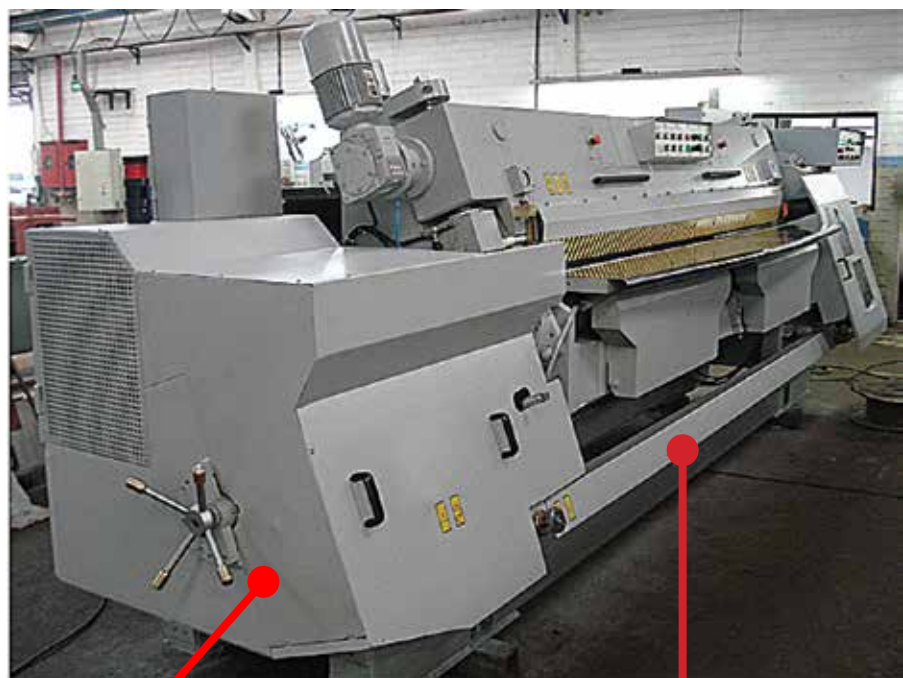
Proteção fixa do volante
