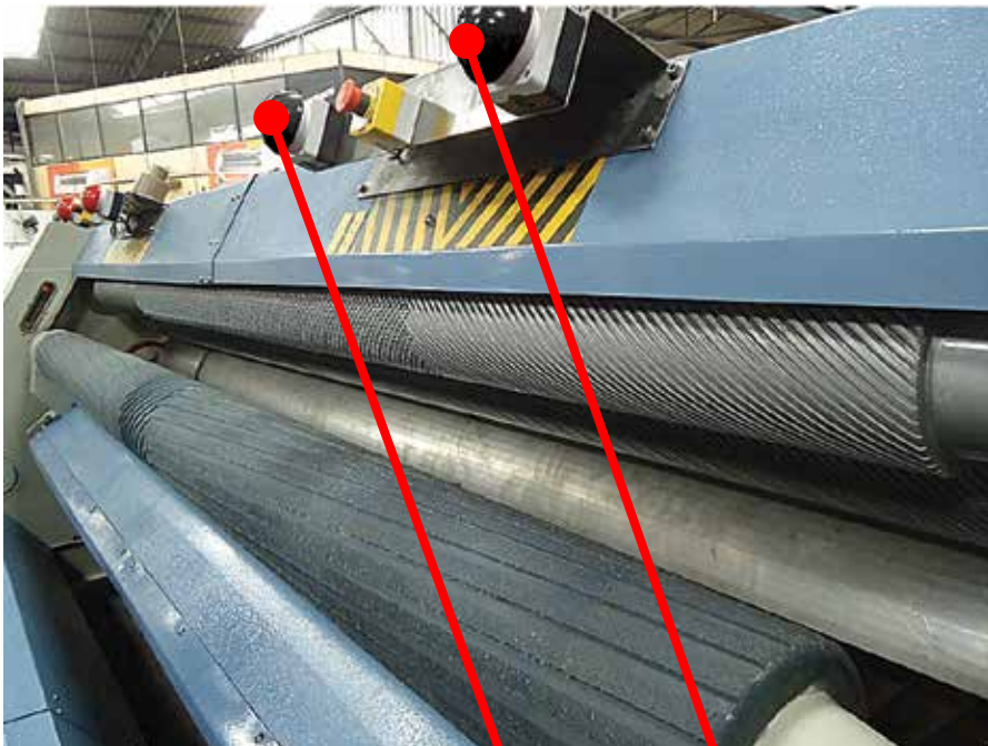
Comando bimanual do tipo IIIC, segundo norma ABNT NBR 14152:1998
