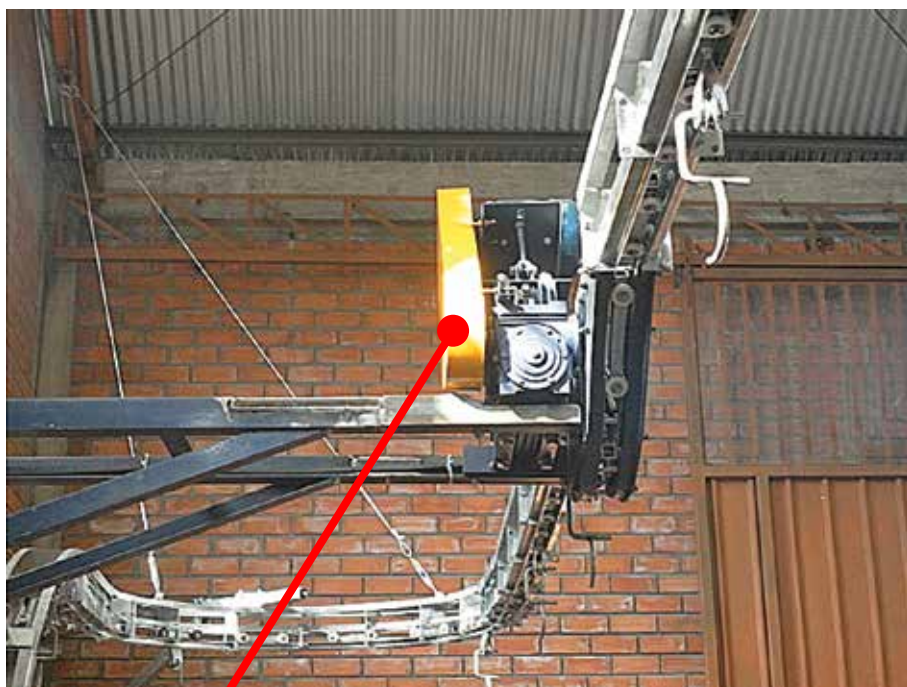
Proteção fixa do mecanismo de transmissão de força
