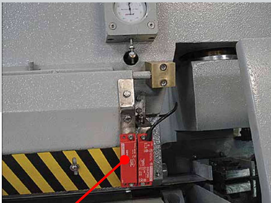
Sensor de segurança da proteção móvel de categoria 4
