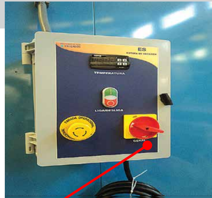
Chave seccionadora que permite o bloqueio
