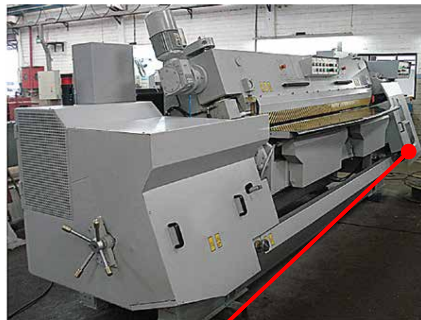
Proteção fixa do mecanismo de afiação da navalha
