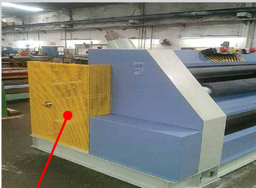
Proteção fixa da parte lateral da máquina
