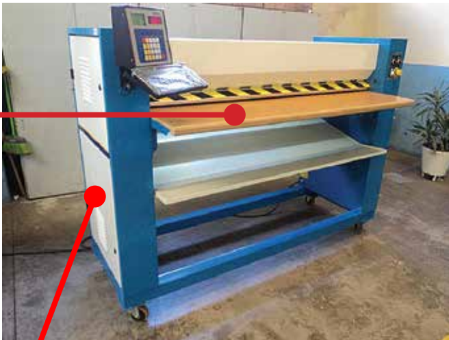
Proteção fixa lateral que impede o acesso aos rolos
