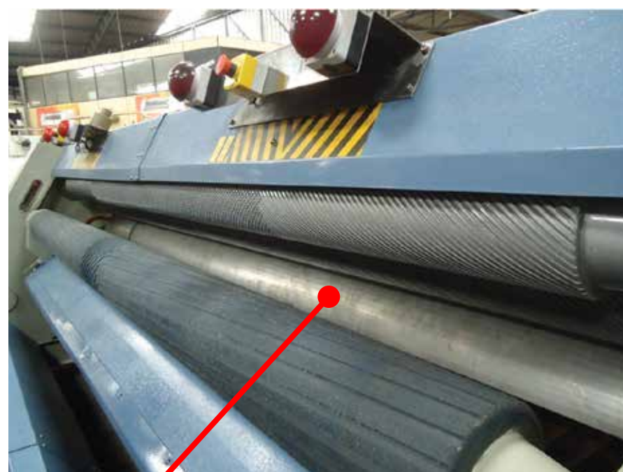
Proteção articulada do rolo de navalhas que impede o acesso de parte do segmento corporal
