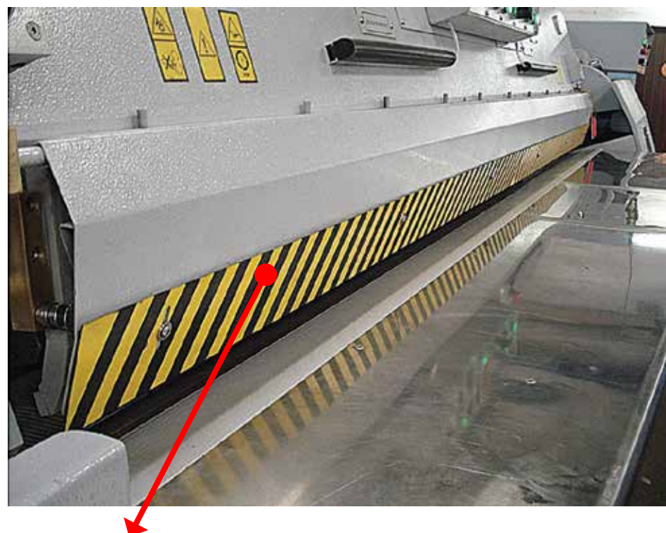
Proteção móvel intertravada que, quando acionada, sobe o cabeçote da máquina, desligando a navalha, o transporte e os afiadores
