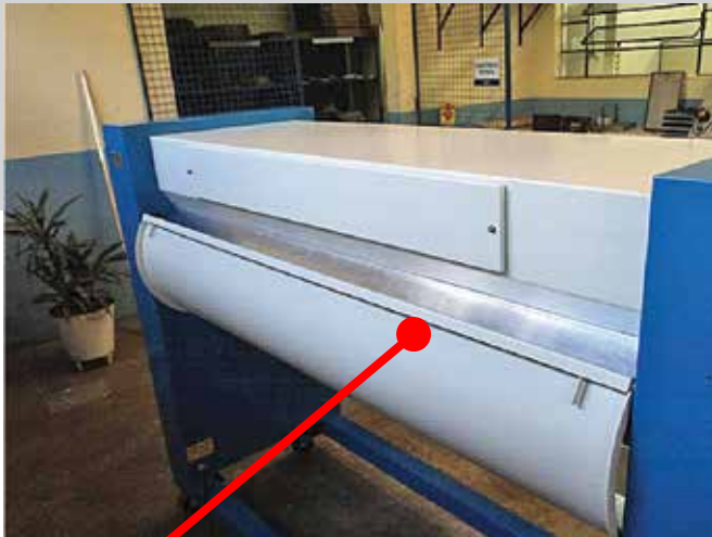
Proteção fixa traseira que impede o acesso aos rolos
